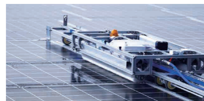
小型洗浄機（工期：3日間/MW）
