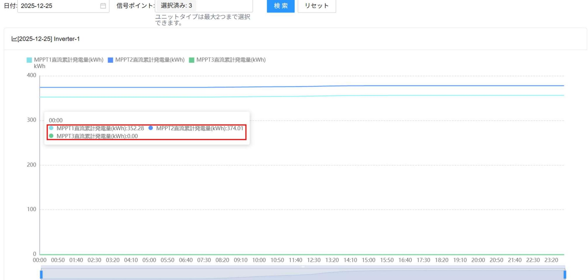
グラフの左端をマウスオーバーして、各MPPT回路の直流累計発電量をメモする
