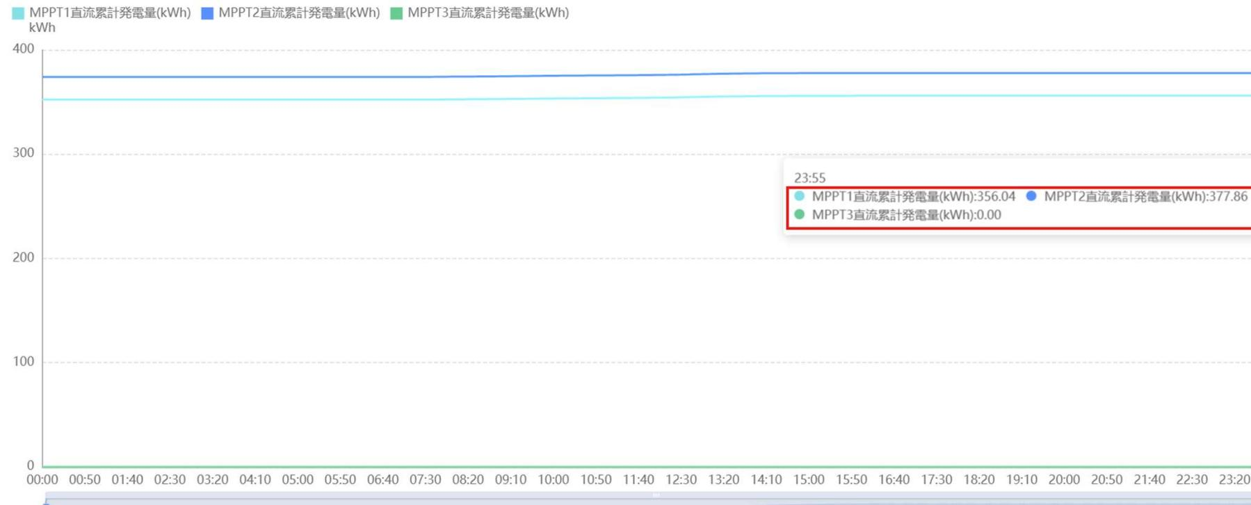
グラフの右端をマウスオーバーして、各MPPT回路の直流累計発電量をメモする
