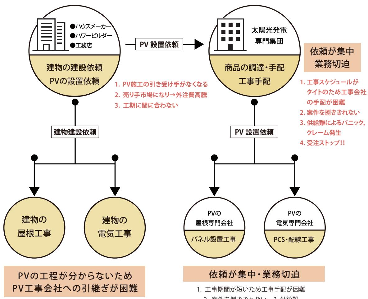
建物とPVの工事責任分界点により担当・役割が分離。建物工事会社もPV工事会社も自らの領域内でのみ工事を行い、PVの工程管理が切り離され効率が悪い。
