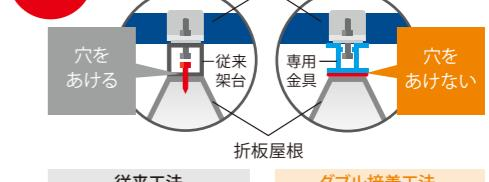
専用金具を接着剤と両面テープで屋根に固定するため、屋根に穴を開ける必要がありません。そのため雨漏りの心配もなく、防水処置も不要です。
