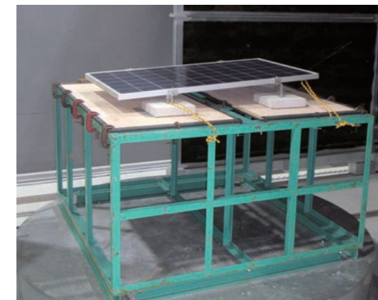
動風圧試験により性能を計測
