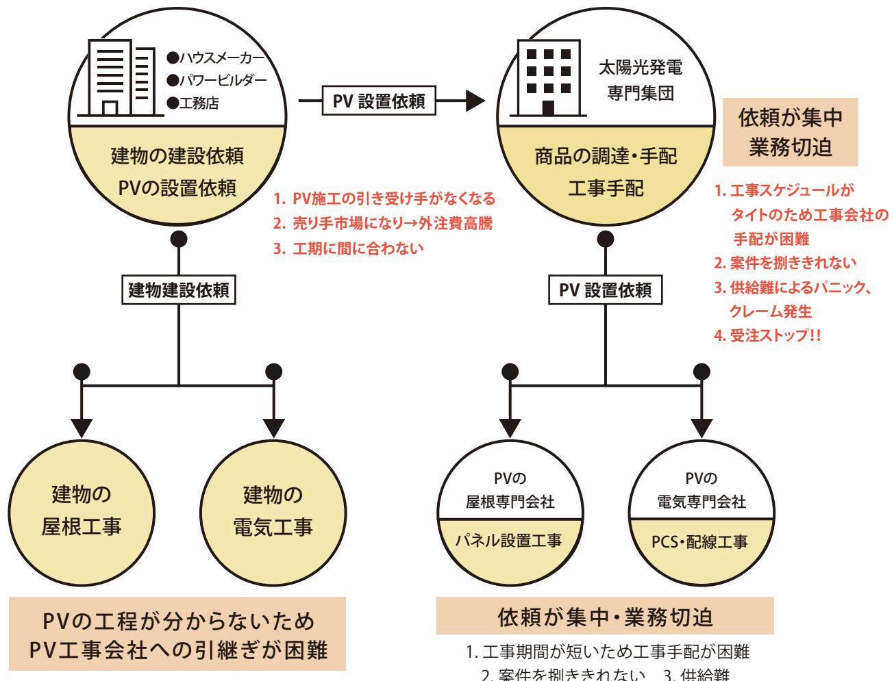
建物とPVの工事責任分界点により担当・役割が分離。建物工事会社もPV工事会社も自らの領域内でのみ工事を行い、PVの工程管理が切り離され効率が悪い。
