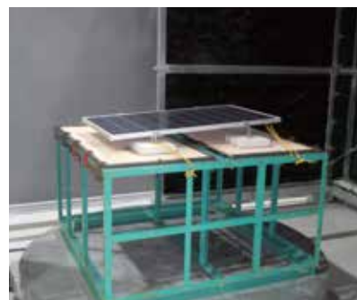
動風圧試験により性能を計測
