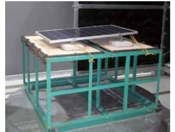
動風圧試験により性能を計測
