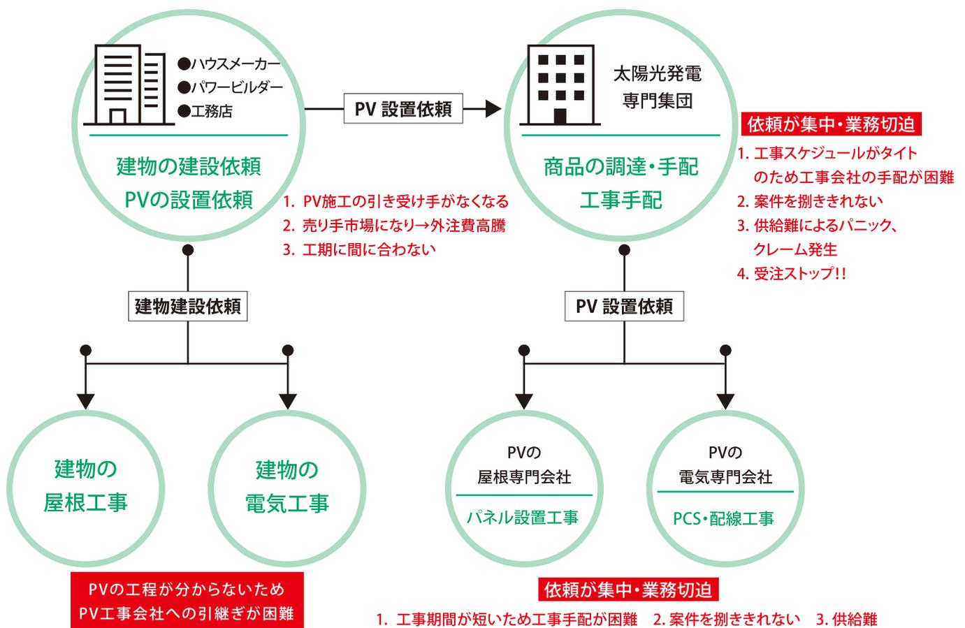
建物とPVの工事責任分界点により担当・役割が分離。建物工事会社もPV工事会社も自らの領域内でのみ工事を行い、PVの工程管理が切り離され効率が悪い。
