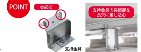
特許取得の「インサートロック方式」を採用。モジュールフレームの固定用長穴を支柱金具の突起部が保持しながら、押え金具でフレームを支持金具に固定します。この方式により、一般的な押え金具方式と比べ、耐荷重性能が大幅に向上しています。
