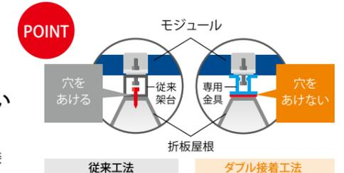
専用金具を接着剤と両面テープで屋根に固定するため、屋根に穴をあける必要がありません。そのため雨漏りの心配もなく、防水処置も不要です。
