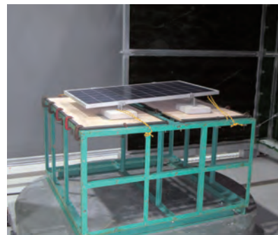
動風圧試験により性能を計測
