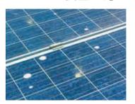
落ち葉、排気ガスなど原因はさまざまですが、モジュー ル表面が汚れると発電量が徐々に低下していきます。ま た、鳥の糞が付着し、長い期間その部分が影になってい ると焼損につながってしまいます。
