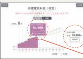
節電目標を超えてしまいそうな月の場合、HEMSが省エネモード搭載の機器に自動的に節電運転を指示
