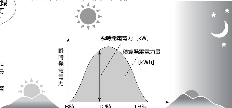
瞬時発電電力とは……パワーコンディショナが出力している発電電力の大きさで単位はキロワット(kW)です。
