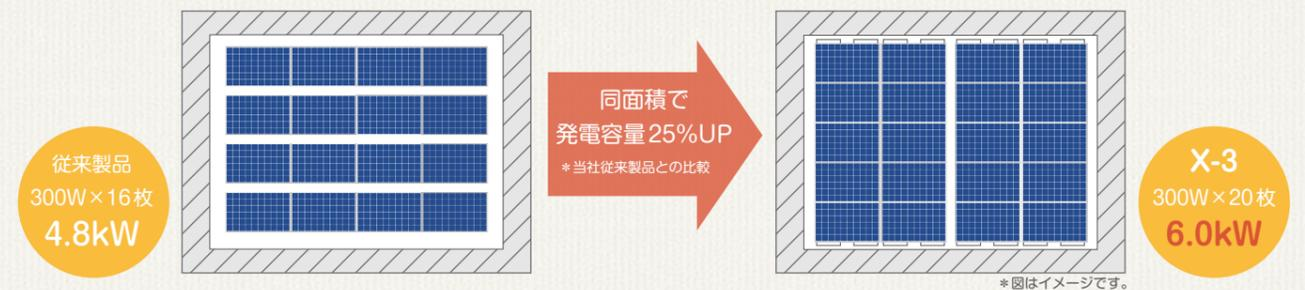
設置角度3度という水平に近い角度のため、地上からは見えにくく、家の外観を損ないません。また、影がでにくいので太陽電池モジュールの間隔をつめて設置でき、屋根面積あたりの発電量を高めることができます。
