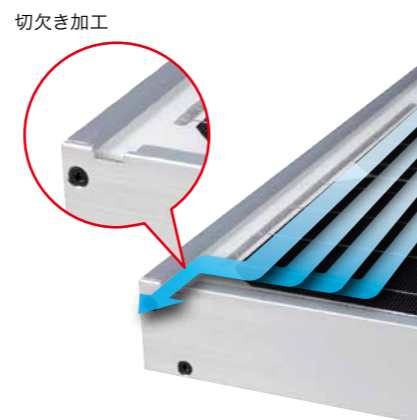
切欠き加工された防汚フレームの水の流れ
