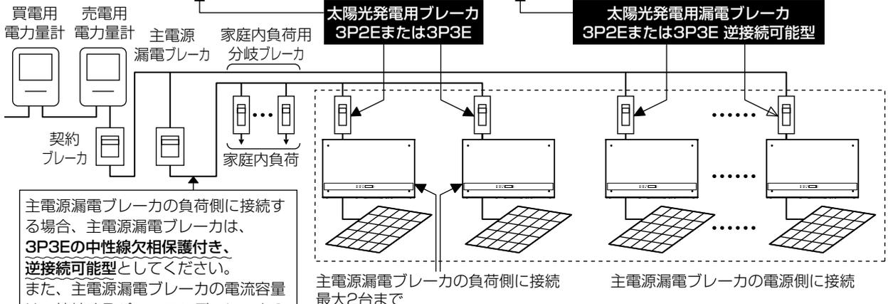
※ パワーコンディショナから太陽光発電用ブレーカへ接続する分電盤接続用ケーブルが16m以上の場合にはプルボックスを配置し、太いケーブルにつなぎ変えてください。（詳細は「現地調達部材」( P5 ) を参照してください)
