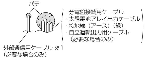
※1: 外部通信用ケーブルは他のケーブルと引き込み口を分離してください。
