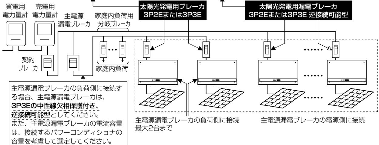
※ パワーコンディショナから太陽光発電用ブレーカへ接続する分電盤接続用ケーブルが20m以上の場合にはプルボックスを配置し、太いケーブルにつなぎ変えてください。（詳細は「現地調達材」( P5 ) を参照してください)
