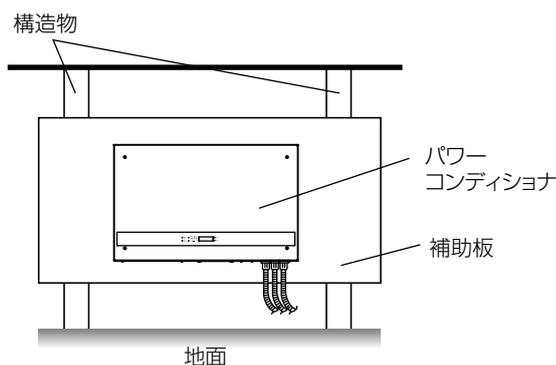
(2) 屋外パワーコンディショナ専用 架台据付部材 三菱電機製 PV-DSK01（別売）を使用する場合
