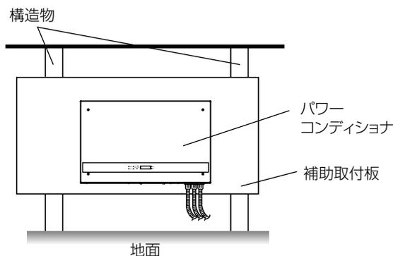
(2) 屋外パワーコンディショナ専用 架台据付部材 三菱電機製 PV-DSK01（別売）を使用する場合
