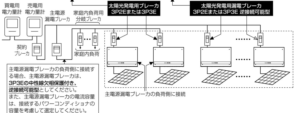
※ パワーコンディショナから太陽光発電用ブレーカへ接続する分電盤接続用ケーブルが16m以上の場合はプルボックスを配置し、太いケーブルにつなぎ変えてください。（詳細は「据付工事説明書」の「現地調達部材」を参照してください）
