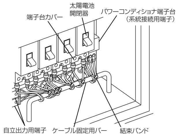
■ ケーブルと太陽電池開閉器の関係 (太陽電池アレイ1の場合)
