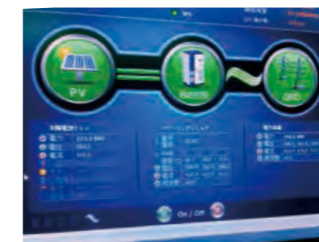
モニタリング画面で発電量と稼働状態を表示。過去の発電量の統計や故障原因の分析、過去の診断履歴の管理機能も装備。
