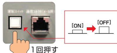
④ 運転スイッチを再度 [ON] にし、運転ランプだけが点灯していることを確認してください。
