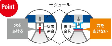
専用金具を接着剤と両面テープで屋根に固定するため、屋根に穴を開ける必要がありません。そのため雨漏りの心配もなく、防水処置も不要です。
