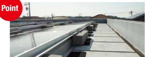
低角度、低背設計なので、隣接する太陽電池モジュールに影響を与える影できにくくなっています。また、滑り止めシートとレール、基礎支持金具を並べ、置き基礎を設置した後に、モジュールを搭載するだけで工事が完了するので屋根を傷めません。
